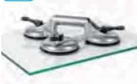
Robuster Aluminium Saugheber mit 3 Saugköpfen zum Tragen und Heben von verschiedenen Lasten. Geeignet für alle Materialien mit planer und gasdichter Oberfläche. Der Saugheber muss mit entspannter Gummischeibe fest auf die anzusaugende Oberfläche gedrückt werden. Beim Umlegen des Kipphebels muss deutlich der Widerstand der Unterdruckerzeugung spürbar sein.
