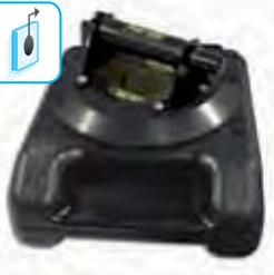
Einer der neuen Pumpensaugheber von Powr Grip® aus der hochwertigen N-Serie. Durch die größere Gummiseibe erhält dieser Saugheber eine höhere Tragkraft (68 kg). Der rote Ring am Pumpenstößel warnt den Benutzer vor bedeutendem Vakuumverlust.
