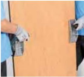
Der Carry Clamp von Bohle ist neuerdings mit einem Rautenbelag aus Gummi ausgestattet. Dieser Gummibelag verhindert ein Abrutschen von nassem Material, insbesondere bearbeitetem Stein oder Marmor. Durch die zwei Klemmbacken wird das Transportgut sicher festgehalten, denn je schwerer die Last, desto höher die Klemmwirkung.
