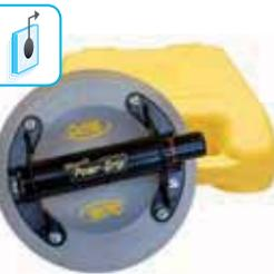
Einer der neuen Pumpensaugheber von Powr Grip® aus der hochwertigen N-Serie. Der gelippte Saugteller saugt sich schnell und einfach auf den nicht porösen, flachen Untergrund an. Die spezielle Mischung dieser Gummiseibe vermeidet Verfärbungen und Abdrücke auf dem Untergrund. Der rote Ring am Pumpenstößel warnt den Benutzer vor bedeutendem Vakuumverlust.
