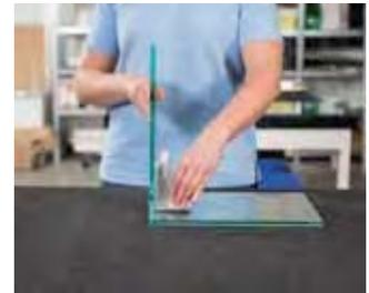
Fixieren Sie den Winkelpumpensauger auf der ersten Scheibe durch Betätigen des unteren Pumpstößels. Der Winkelpumpensauger saugt sich an das Glas an und hat nun die richtige Ausgangsposition.
