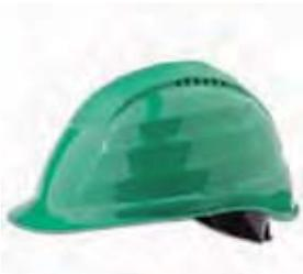
Helmschale PE · Regenrinne · Stecktaschen für Gesichts-/Gehörschutz · seitliche Belüftung · Vier-Punkt-Gurt mit Schweißband · Formbeständigkeit bei Hitze: bis ca. 70 °C · Bruchfestigkeit bei Kälte bis ca. -40 °C · laut Berufsgenossenschaft nicht länger als 5 Jahre nutzen · nach hartem Schlag nicht mehr verwenden!
