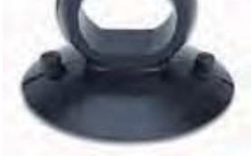
Zum Anheben und Öffnen von diversen kleinen Teilen einzusetzen, z. B. Öffnen von Kabelkanälen. Das Vakuum wird erzeugt, indem der Sauger einfach mittig auf den Untergrund gedrückt wird. Durch leichtes Anheben der seitlichen Lösenoppen mit Daumen oder Zeigefinger wird der Sauger wieder vom Untergrund gelöst.
