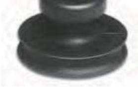
Der Vollgummisauger von Veribor® dient zum Heben und Bewegen von diversen Lasten. Er ist gut geeignet zum Halten von kleinen Gegenständen oder zum Öffnen der Abdeckungen von Kabelschächten. Das Vakuum wird erzeugt, indem der Knauf des Saugers einfach auf den Untergrund gedrückt wird, dadurch erzielt der Anwender eine schnelle und effektive Arbeitsweise. Durch leichtes Anheben der umlaufenden Gummilippe mit Daumen oder Zeigefinger wird der Sauger wieder vom Untergrund gelöst.
