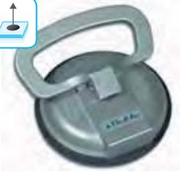
Der 1-Kopf-Saugerheber aus Alu-Druckguss ermöglicht in einem einfachen Arbeitsgang das senkrechte Anheben und Bewegen von leichten gasdichten Materialien bis zu einem Gewicht von 15 kg. Dieser Saugheber ist sehr gut geeignet zum Verlegen von Fliesen - für eine schnelle und effektive Arbeitsweise von unhandlichen Teilen.
