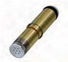
Generell hat der Anwender bei Pumpensaugermodellen eine optische Vakuum-Verlustanzeige am Pumpenstößel, d. h., sobald der rote Ring am Stößel sichtbar wird, muss nachgepumpt werden, somit ist eine visuelle Kontrolle des Vakuumverlustes garantiert. Dieser Pumpenstößel allerdings hat eine zusätzlich akustische Vakuumanzeige, welche ein lautes Signal gibt, sobald ein Vakuumverlust auftritt
