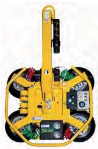
Mit 3 Rahmen-Konfigurationen, einer 360° Drehbewegung sowie der 90° Schwenkmöglichkeit ist diese Powr-Grip® Hebeanlage problemlos auf viele Arbeitssituationen anzupassen und bietet damit maximale Vielseitigkeit, sei es in der Werkstatt oder auf der Baustelle. Wie alle von Böhle vertriebenen Standard-Hebeanlagen von Wood's Powr-Grip® verfügt auch dieses Gerät durch sein 2-Kreis-Vakuumsystem über eine besonders hohe Sicherheit. Die Tragfähigkeit beträgt 320 kg.
