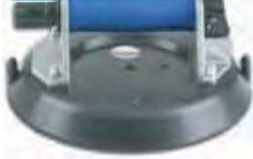
Pumpensaugheber aus Aluminium mit spezieller Gummischeibe (220 mm) für gewölbte und stark strukturierte Oberflächen. Anzusaugender Radius mind. 500 mm. Durch seine stark gewölbte Gummischeibe muß dieser Saugheber fest auf den anzusaugenden Untergrund gedrückt werden, erst dann wird durch Betätigen des Pumpenstößels die Luft zwischen dem Untergrund und der Saugscheibe evakuiert. Permanente visuelle Kontrolle des Vakuums durch den roten Ring am Pumpenstößel.
