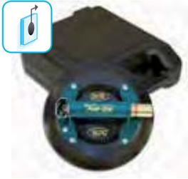
Saugheber von Powr Grip® für gasdichte Materialien. Besonderheit dieses Saughebers ist die höhere Tragkraft (68 kg) als des N4950 durch eine größere Gummischeibe (230 mm Ø). Der rote Ring am Pumpenstößel warnt den Benutzer vor bedeutendem Vakuumverlust.
