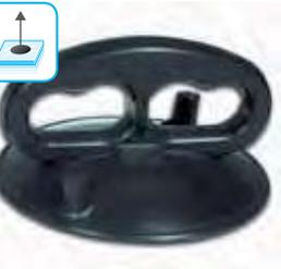
Zum Anheben und Öffnen von diversen Teilen einzusetzen, z. B. Öffnen von Kabelkanälen. Das Vakuum wird erzeugt, indem der Sauger einfach mittig auf den Untergrund gedrückt wird. Durch leichtes Anheben der seitlichen Lösenoppen mit Daumen oder Zeigefinger wird der Sauger wieder vom Untergrund gelöst.
