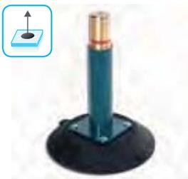
Saugheber aus Metall zum Manipulieren von Gegenständen wie Kunststoff, beschichtetes Holz, Glas. Besonderheit: durch die gebogene Gummischeibe auch für gebogene Oberflächen bis zu einem Mindestradius von 305 mm geeignet.
