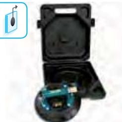
Der Pumpensaugheber von Powr Grip® mit griffsicherem stabilem Handgriff aus Metall eignet sich zum Transport von gewölbten und gasdichten Oberflächen. Durch die große gewölbte Gummiseibe (250 mm Ø) ist dieser Saugheber besonders für gebogenes Glas geeignet. Permanente visuelle Kontrolle des Vakuums durch den roten Ring am Pumpenstößel.
