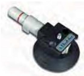
Dieser Saughalter eignet sich sehr gut zum Montieren von Endprodukten. An den Gewindezapfen (1/4") können diverse Teile angeschraubt werden, um Meßvorgänge durchzuführen z. B. Kamera. Sicherheit durch visuelle Kontrolle des gesamten Vakuums durch die Markierung des roten Rings am Pumpenstößel. Optional kann ein Adapter von 1/4" Gewinde auf M6 (BO 6024) oder 1/4" Gewinde auf M8 (BO 6023) bestellt werden.
