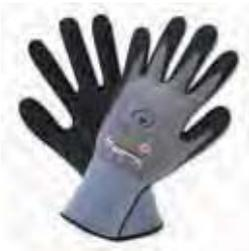
Feinstrickhandschuh aus Nylon-Spandex-Gewebe mit Polyurethan-Nitrilschaum-Beschichtung der Handinnenfläche und der Fingerkuppen, mit Strickbund. Der Handschuh ist exzellent in Passform und Tastgefühl und hat einen angenehmen Tragekomfort. Er weist eine hohe Abriebfestigkeit auf und hat einen guten Naß- und Trockengriff. Er ist gefertigt nach EN 388, Kat. II und nach Oeko-Tex-Standard 100. Für alle Montagetätigkeiten. Leicht und atmungsaktiv
