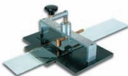
Speziell für den Serienrundschnitt kleiner, runder Scheiben von 10 - 185 mm  $\varnothing$  · schleppend geführtes HM-Schneidrad mit 155° Schneidenwinkel · unterschiedliche Schneidenwinkel für verschiedene Glasdicken separat erhältlich · Verlängerungsplatten aus Hartpapier nur separat erhältlich
