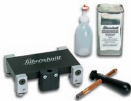
Einsetzbar mit Bohle Schneidlinealen (10 mm) · zusammen mit dem Silberschnitt® Ölglasschneider 2000.P POWER (im Set enthalten) wird durch das nachlaufende Rädchen und den integrierten Auftrag von Schneidflüssigkeit ein hervorragendes Ergebnis erzielt. Bei Glasdicken von 25 mm empfehlen wir Rädchenträger BO 2449.8 mit 160°.
