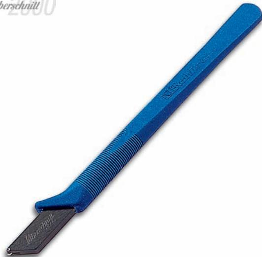
Glasschneider in Silberschnitt® 2000 Qualität · Toplife Schneidrädchen · Kunststoffgriff in traditioneller Glaserform · kann zum Brechen unter den Schnitt gelegt werden · extrem leichte Kopfplatte aus spezieller Metalllegierung · sehr feiner, leichter Lauf · ein idealer Universal-Glasschneider · Rädchen nicht austauschbar
