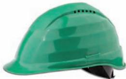
Helmschale PE · Regenrinne · Stecktaschen für Gesichts-/Gehörschutz · seitliche Belüftung · Vier-Punkt-Gurt mit Schweißband · Formbeständigkeit bei Hitze: bis ca. 70°C Bruchfestigkeit bei Kälte bis ca. -40°C · laut Berufsgenossenschaft nicht länger als 5 Jahre nutzen · nach hartem Schlag nicht mehr verwenden!
