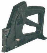
Der Framemaster ist ein Rückwandhandtacker mit drehbarem Schussmagazin, in dem 10 mm (Glazier points) oder 16 mm (Framers points) lange Stahlplättchen in die Holzleiste über der Rückwand flach eingeschossen werden - die Schusskraft ist über eine Stellschraube einstellbar.
