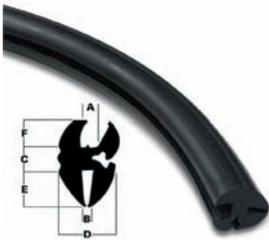
Die Gummiklemmprofile sind so abgebildet, dass die Scheibenaufnahme (A) stets nach oben und die Falzaufnahme (B) nach unten zeigt · die angegebenen Biegeradien (r) sind die Kleinste Maße · Tabelle: alle Angaben in mm
