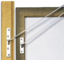
Werden seitlich auf den Holzrahmen geschraubt · der Bilderdraht / Perlonkordel wird durch die Schlaufen, die innen zur Schonung des Drahtes abgerundet sind, gezogen und verknotet · paarweise verpackt, werden die Ösenplatten mit Schrauben geliefert.
