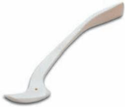
Mit dem flachen Endstück werden Bleiprofile nach dem Verkitten zugedrückt
