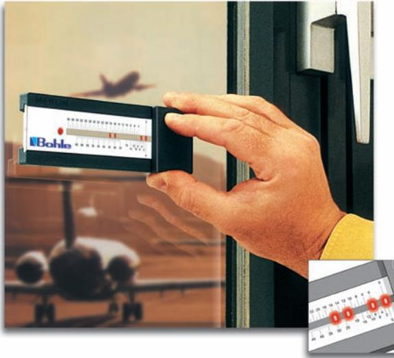
Zur Glasanalyse · Laserdiode mit hochsensibler Messelektronik
