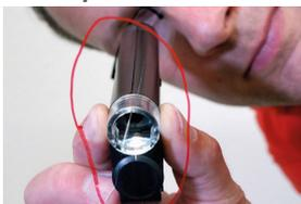
Prüfen Sie die Oberfläche mit der Lupe. Der Kratzer wird jetzt in 30-facher Vergrößerung angezeigt.
