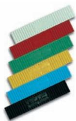
Geprüftes, dichtstoffverträgliches Material · universell einsetzbar durch querverrifelte Oberfläche und stabile Unterseite · die Form der Klötze garantiert eine bündige Anschlagverklotzung an der Glasfalzinnenkante · Hergestellt in Übereinstimmung mit den Technischen Richtlinien des Glaserhandwerks Nr. 3 „Klotzung von Verglasungseinheiten“
