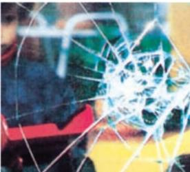
Schutz von Verglasungen · erhöhte Widerstandsfähigkeit von normalem Glas gegen Druck, Schlag und Stoß · Polyesterfolie verringert Verletzungen und Sachschäden durch Splitter · absorbiert bis zu 98% der UV-Strahlung
