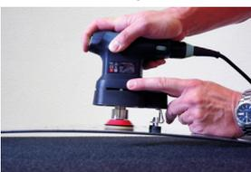
Legen Sie die Polierscheibe mit dem Klettverschluss auf den Scheibenträger. Befeuchten Sie den Kratzer mit Wasser und bewegen Sie das eingeschaltete Gerät mit einer gleichmäßigen Spiralbewegung langsam über den Kratzer hin und her. Stoppen Sie nach 30 Sekunden. Entfernen Sie den Abrieb mit dem Gummischutzkragen und prüfen Sie die Kratzerstelle. Wiederholen Sie diesen Vorgang so lange, bis der Kratzer entfernt wurde.
