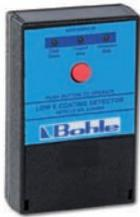
Zur Erkennung und Positionsbestimmung der „Low-E“-Beschichtung auf Einfachglas und Zweischeiben-Isolierglas (4 - 10 mm Glasdicke der Einzelscheibe). Beim Zweischeiben-Isolierglas muss von beiden Seiten gemessen werden, um die Position der Beschichtung zu bestimmen.
