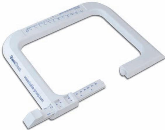
Der GlassCheck eignet sich zur Messung der Gesamtglasstärke von Scheiben oder Isolierverglasungen im eingebauten Zustand. Es können Stärken von bis zu 120 mm gemessen werden. Zusätzlich ist in dieses Gerät ein optischer Glasdickenmesser integriert. Dadurch ist es möglich, die Glasdicke der einzelnen Scheibe abzulesen (2 bis 25 mm).
